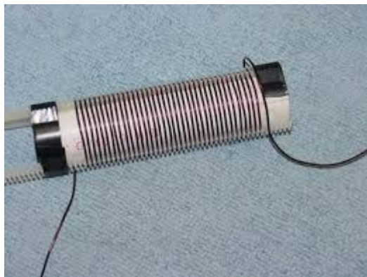
Przykładowa cewka skracająca (ang. loading coil)
