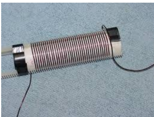
Przykładowa cewka skracająca (ang. loading coil)
